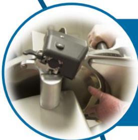
**Al disponer la pieza a cortar sobre el carro usar los medios disponibles para la sujeción y protección de la misma.**
