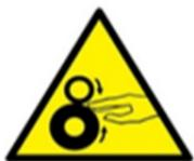
**En el caso de que alguna parte de la pieza a cortar se quede enganchada no desatascar la máquina mientras esté en funcionamiento. Desconectar el equipo de la toma de enchufe y extraer el objeto que la bloquea.**
