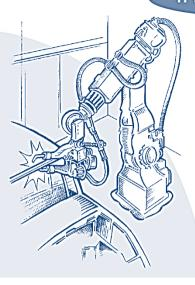
Soldadura es una denominación genérica para definir la unión de piezas de metal por sus caras de junta. Este efecto se consigue haciendo que las piezas se vuelvan plásticas o líquidas mediante la aplicación de calor o presión, o ambas cosas.
