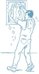
**1** Abrir la puerta del armario o romper el cristal colocando delante un paño o papel. Retirar los trozos de cristal usando alguna protección.
